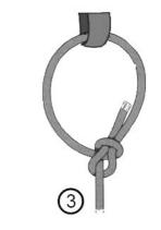
Fig. 5. Palstek-knot
